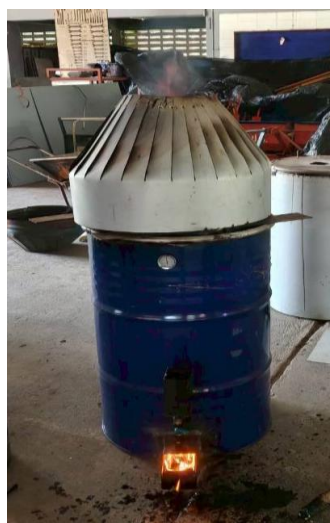
ภาพที่ 4.1 เตาอบถ่านไร่คว้นรูปแบบแนวตั้งทั่วไป และ เตาอบถ่านไร่คว้นรูปแบบ (ห้องเผาไหม้คู่)
