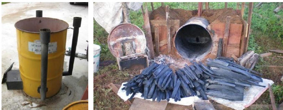
ภาพที่ 2.4 แสดงลักษณะของเตาเผาถ่าน 200 ลิตรแบบแนวดิ่งและแนวนอน
