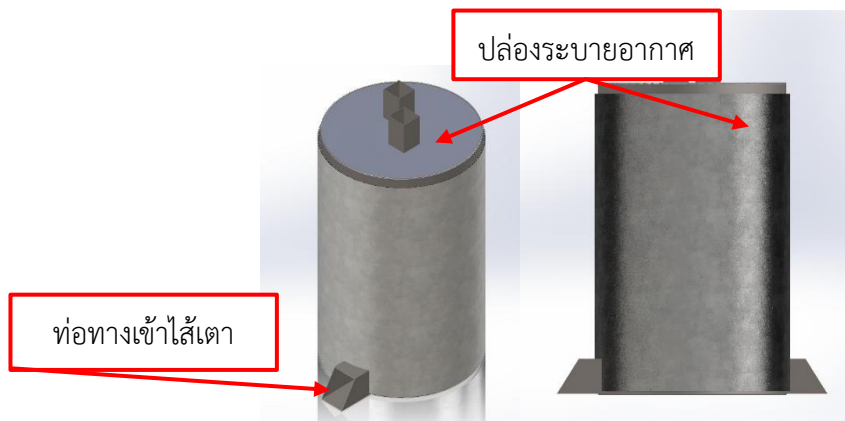
ภาพที่ 3.2 เตาเผาถ่านไร้ควันแบบใส่ L แบบ สองใส่เตาที่ออกแบบ
