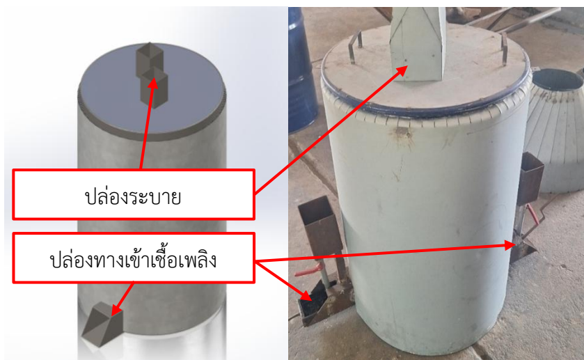
ภาพที่ 3.10 ต้นแบบเตาเผาถ่านแบบสองไส้เตา
