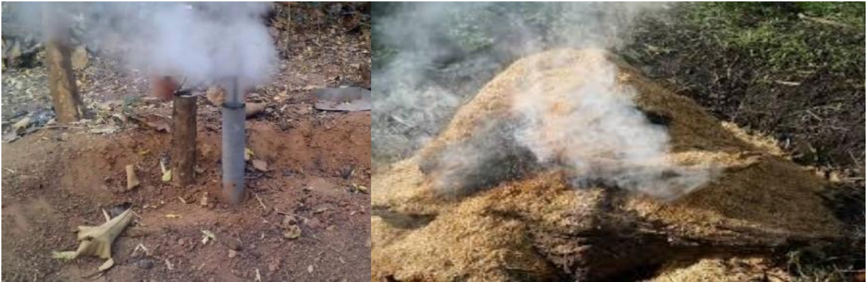
ภาพที่ 2.2 ลักษณะของเตาหลุมผีและเตาเกลบ
