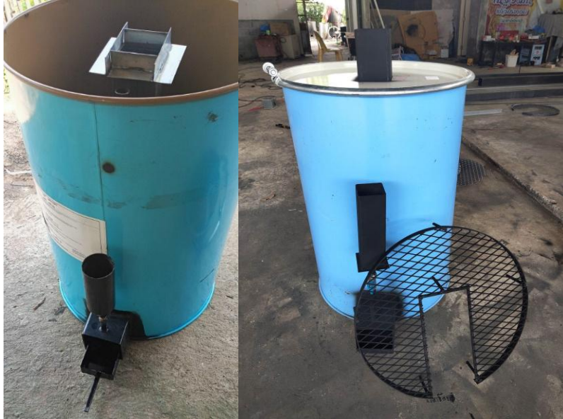
ภาพที่ 3.1 เตาเผาถ่านไร้ควันแบบใส่ L ที่ขายทั่วไป
