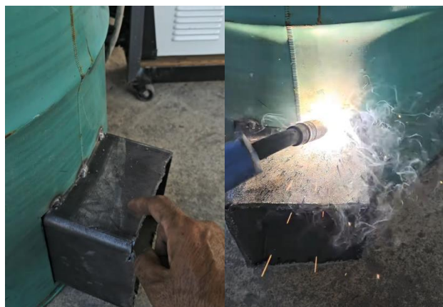
ภาพที่ 3.7 ประกอบเตาและเชื่อมต่อห้องเผาไหม้หลักและรองเข้าด้วยกัน
